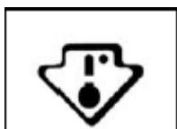
In Ihrem Kühlschrank befindet sich nebenstehendes Symbol. Es gibt eindeutig den kältesten Bereich im Gerät an. Die Temperatur ist dort unter oder gleich + 4°C. In diesem Bereich ermöglicht eine Temperaturanzeige die korrekte Einstellung des Kühlschranks.
