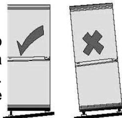
Si el aparato no está nivelado, la junta de la puerta y la alineación magnética se verán afectadas. Una vez colocado el aparato en su posición definitiva, ajuste los pies ajustables de la parte delantera girándolos.
