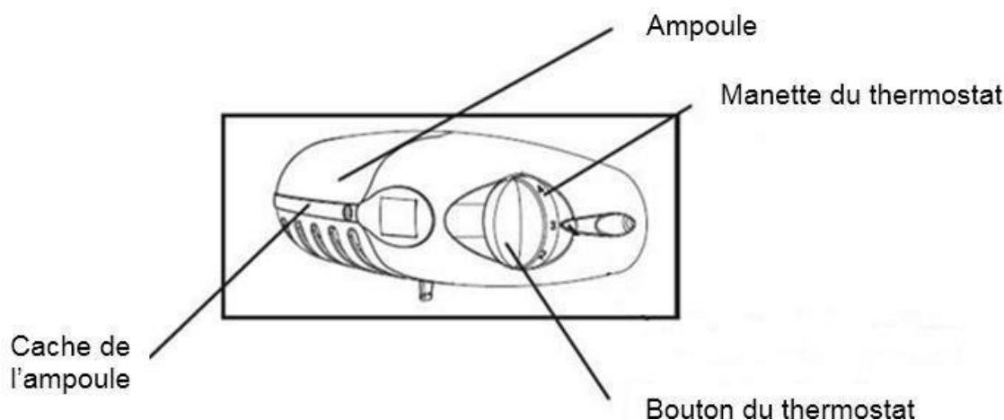
Su aparato está equipado con un termostato situado en el interior de la parte superior del aparato.
