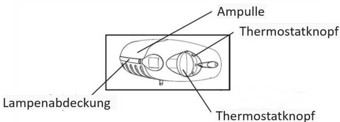
Ihr Kühlschrank ist mit einem Thermostat ausgestattet, der sich im Inneren des Geräts befindet.
