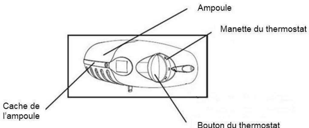
Votre appareil est équipé d'un thermostat situé à l'intérieur en haut de votre appareil.
