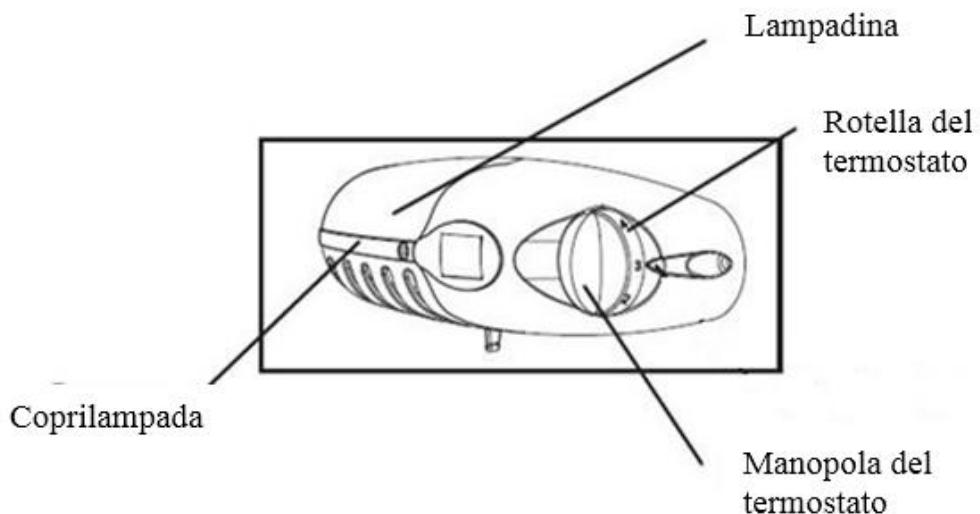
Il frigo è dotato di un termostato per regolare la temperatura. Il controllo della temperatura si trova nella parte superiore del dispositivo.
